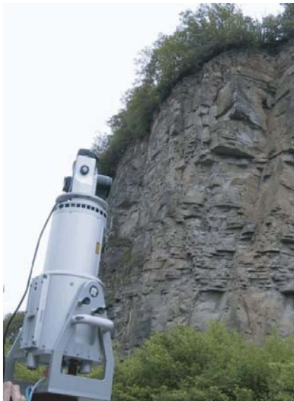
Laser scanner Z210ii montato e posizionato per il rilievo
