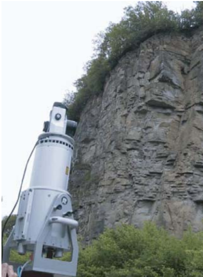
Laser scanner Z420i montato e posizionato per il rilievo
